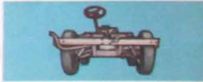
— A versão de suspensão — sistema de CANDANGO DKW-VEMAG — é independente nas 4 rodas e utiliza o sistema de suspensão mais sofisticado, absorção e amortecimento de choques de alta qualidade. O sistema de suspensão do CANDANGO DKW-VEMAG são independentes entre si.
